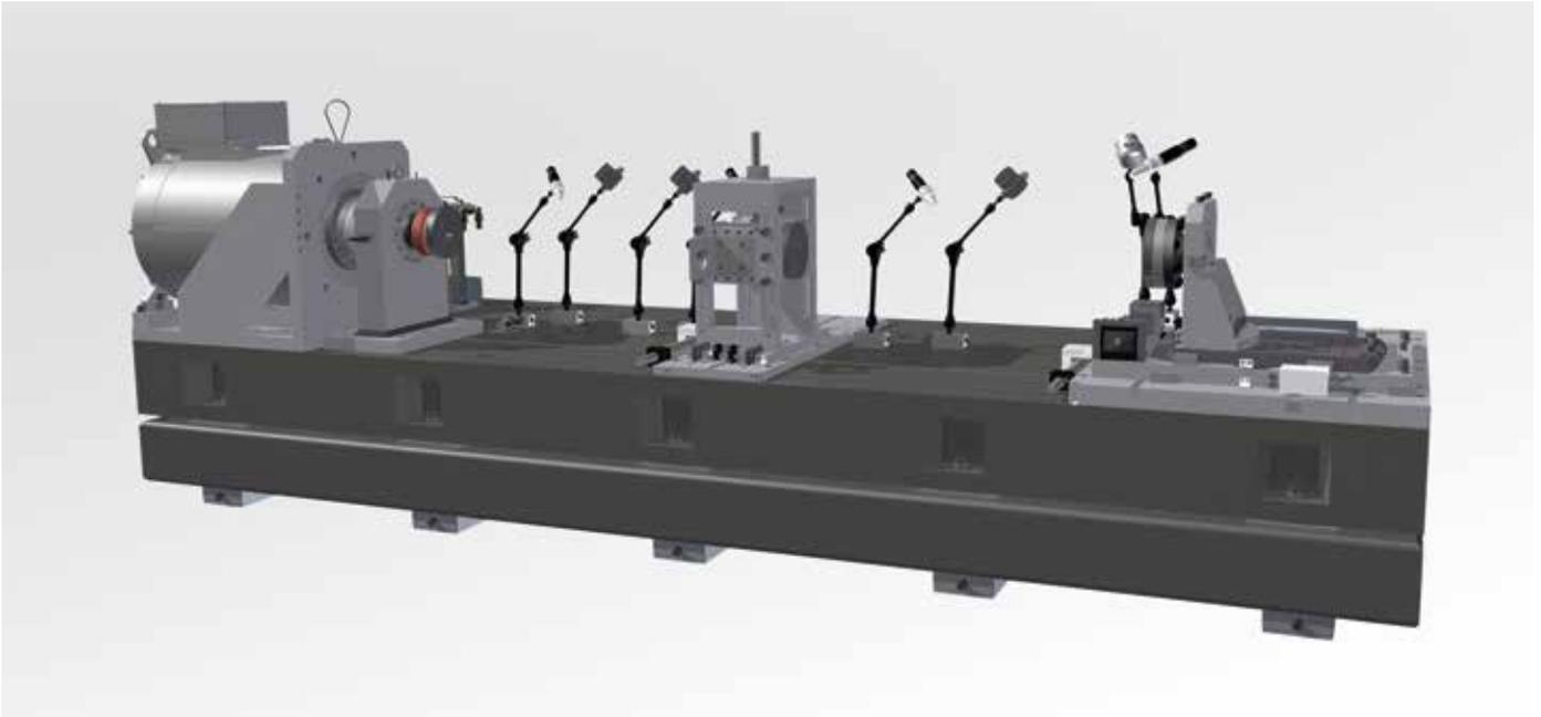
Der Prüfstand wird für Torsionsermüdungs- und statische Festigkeitsprüfungen von Gelenkwellen verwendet. Die Tests werden mit vorgegebenen Lasten und Versuchsaufbauten durchgeführt, um eine erforderliche Anzahl von Zyklen zu erreichen. Abschaltkriterien sind entweder das Erreichen definierter Torsionswinkel oder der Bruch des Prüflings.
