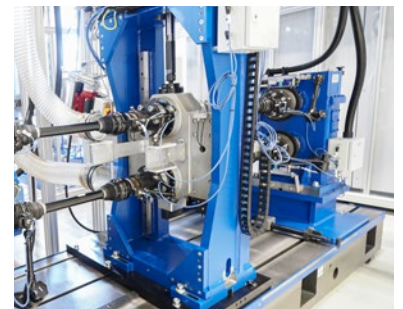
Pulsator für die Simulation einer Fahrstrecke
