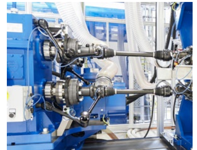
Fahrtwindsimulation und Temperaturmessung
