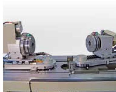
左侧电机驱动摆角调整单元和右侧手动摆角调整单元
