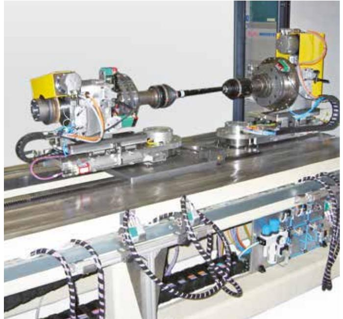
Der Prüfstand dient der Messung von Funktionswerten an Gelenken und Gelenkwellen. Mit dem Funktionsprüfstand werden folgende messtechnischen Versuche durchgeführt:
