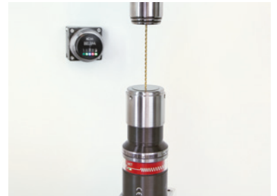
小径工具の工具長測定と折損検知
