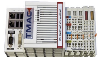
TMAC IPC przetwarza dane z przetwornika mocy i przekazuje je jako polecenia CNC, oraz komunikuje się z zewnętrznym komputerem PC.
