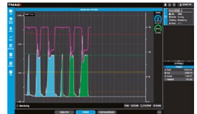
Adaptive Control: Vizualizace nastavení posuvu & aktuálního řezného výkonu
