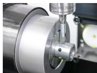
Scansione analogica di un foro conico oblungo
