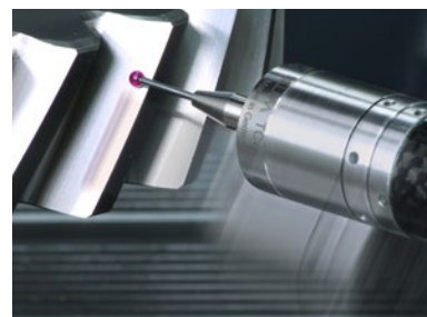
Rilievo degli errori di lavorazione su una rettificatrice per ingranaggi
