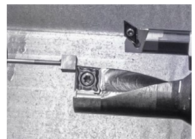
Medição de peças na máquina de ferramenta em um Torno
