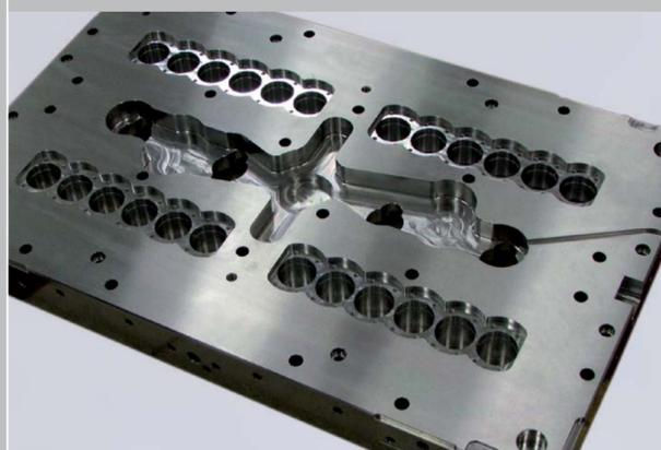
“产量是惊人的。例如，1个96孔模具的注塑频率为3.5秒，每天能够生产26吨PET盖，足够装载一辆卡车！”执行董事Stanislav Vesely指出，“生产量如此之大，即使减少3-5%的塑料消耗，也意味着一笔巨大的费用。因此，产品的价格压力导致产生了这样的特定需求：在模具上布置尽可能多的孔，同时确保最紧密的公差，孔的位置精度会影响PET盖的壁厚，并影响塑料的消耗量和成本。
