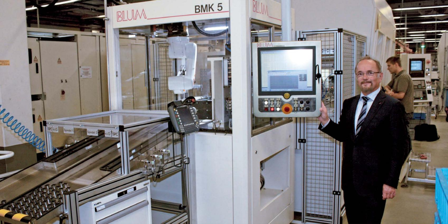
BMK 5单元能够完全满足上述要求。当前的生产流程采用随机采样来进行监测。在加工了约150个工件后，机械装置将母模（放在测量装置内）放入测量设备然后系统会进行自行校准。机器停工后或根据操作员的调动，系统也会自动进行校准。新设备现在运转非常顺利，每小时可制造和测试180个零件，每天分三班进行操作。经过改装，设备和测量单元可轻易地处理不同种类的真空泵转子。
